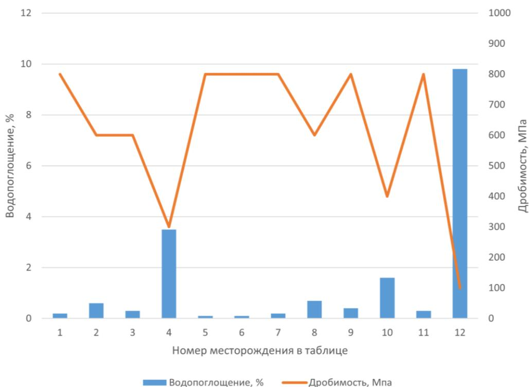
Рисунок 1 – Зависимость показателя дробимости от водопоглощения
