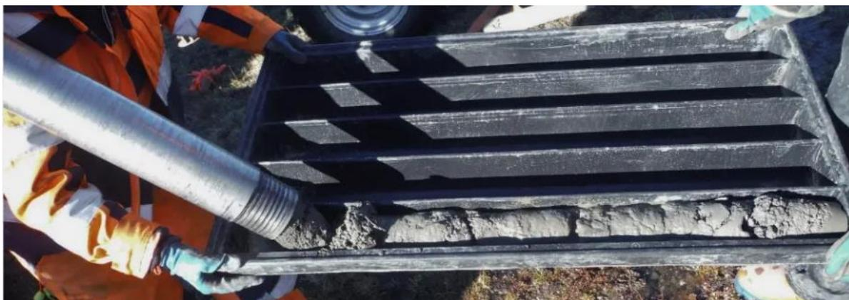
Рисунок 1 – Пример пробы из рыхлых отложений при ультразвуковом бурении (фото SRK Exploration)
