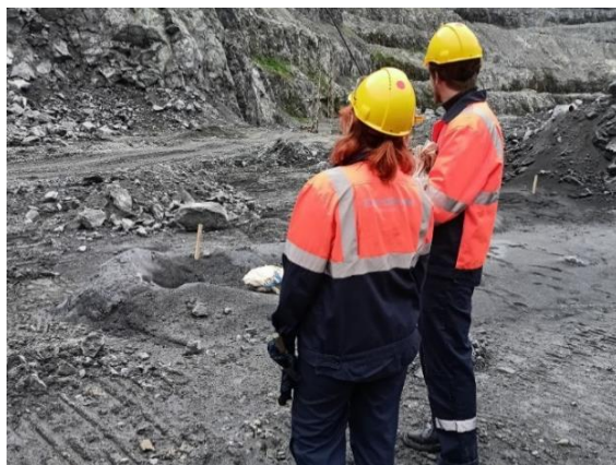
Рисунок 1 – Эксплуатационное опробование скважин буровзрывных блоков
