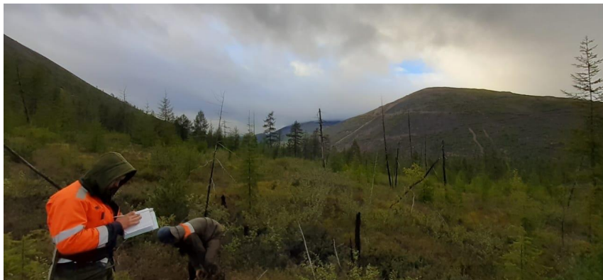
Рисунок 2 – Геологический маршрут, отбор геохимических проб по методу ММІ
