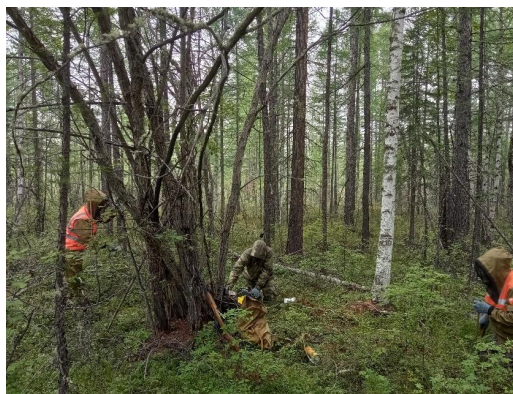
Рисунок 2 – Производство работ методом ВЭЗ четырехэлектродной симметричной установкой
