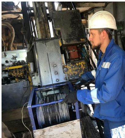
Рисунок 1 – Проведение инклинометрии скважины
