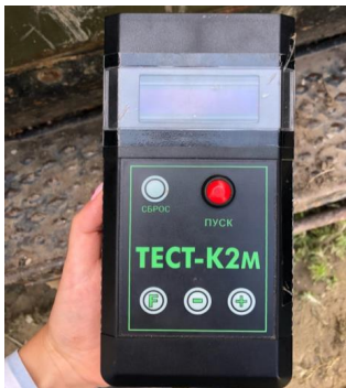
Рисунок 1 – Оборудование для статического зондирования «Тест К-2»
