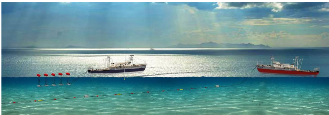
Рисунок 2 – Возбуждение упругих колебаний с регистрацией данных
