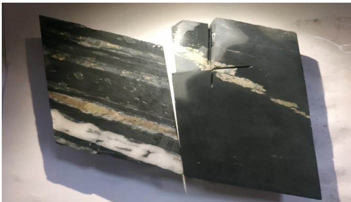
Рисунок 1 – Послойный, вкрапленный и секущий типы руды
