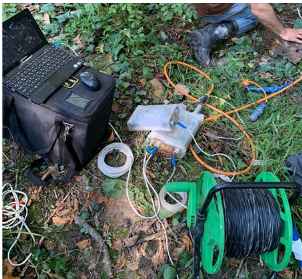
Рисунок 1 – Общий вид цифровой инженерной сейсмостанции «Лакколит 24-М»
