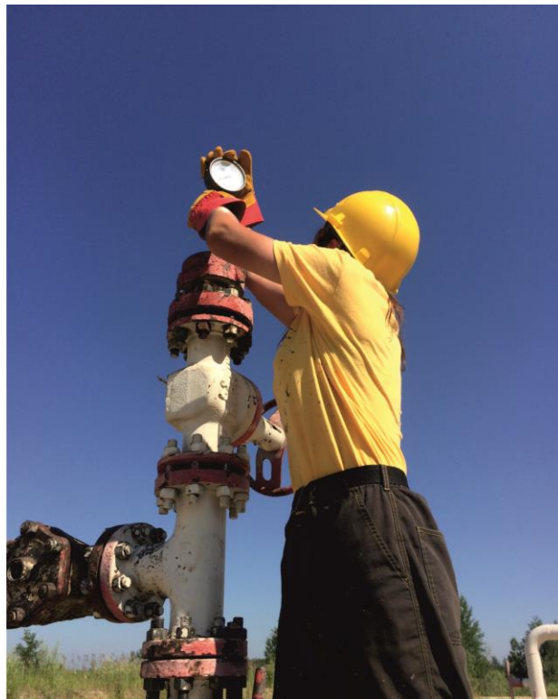
Рисунок – Рабочие моменты: покраска нефтепромыслового оборудования (слева) и измерение буферного давления в скважине с помощью манометра (справа)
