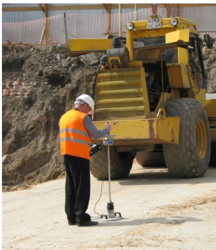
Рисунок – Динамические испытания грунта с помощью плотномера ZORN ZFG 3.0
