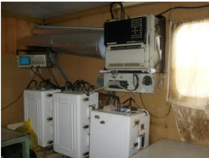
Рисунок 1 – Телеметрическая сейсмостанция Input/Output-2
