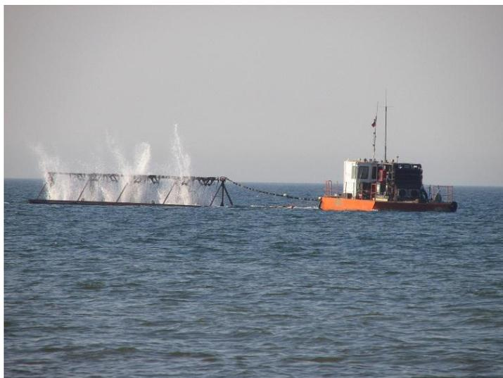
Рисунок 2 – Возбуждение сигнала групповым пневматическим источником
