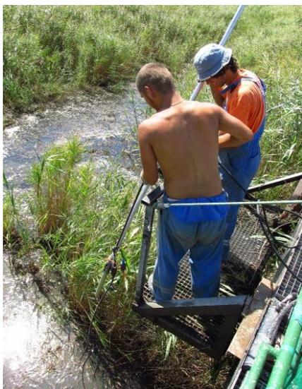
Рисунок 1 – Установка датчика СВГ-6
