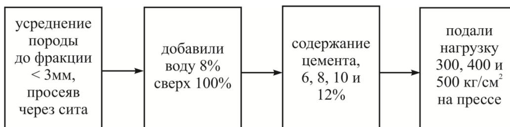
Рисунок 2 - Схема переработки отходов добычи пильных известняков Крыма для получения инновационных материалов
