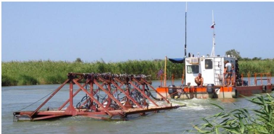
Рисунок 2 – Плот-носитель с групповым пневматическим источником
