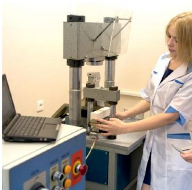
Рисунок 3 - Испытание образцов гипсового вяжущего на прочность
